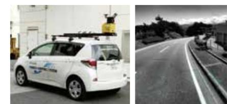
車両に搭載された3次元レーザ計測機によりひび割れを検知。道路の状態を可視化します。[資料提供 (株)東芝・(株)トプコン]
