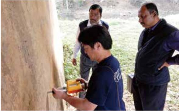
シュミットハンマーによる橋脚の強度確認の様子。近接目視により、数多くの損傷を発見した。
