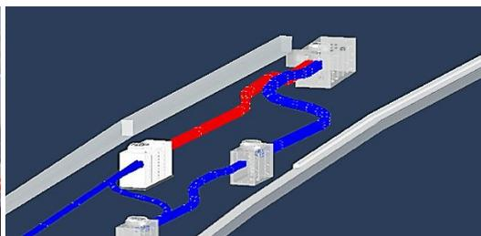
【電線共同溝管路の自動設計システム】
