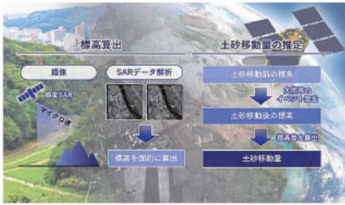
標高の算出から土砂移動量を推定するイメージ（報道発表資料から）
