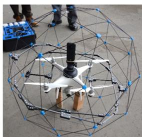
橋梁等の近接点検を安全に実施するために、万が一接触した場合でも衝撃を吸収する球体ガードを装着したドローン
