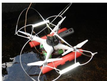
水路や溝橋など、狭い空間を、水面から360°カメラで撮影・点検するためのドローン。土砂だまりや浮遊物を浮上して回避しながら点検が続けられるのが特徴。
