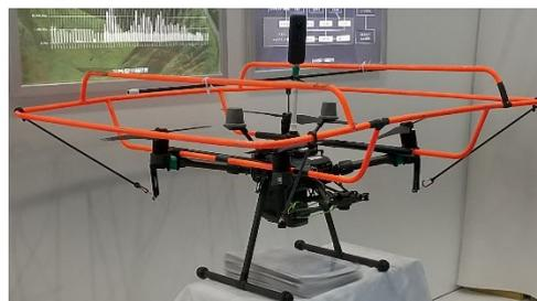
主に水管橋を点検するためのガードを装着したドローン。360°カメラの他に、高解像度カメラと赤外線カメラを装着可能。赤外線カメラは漏水箇所を発見するために利用する。またトータルステーションと連動した自動航行も可能。
