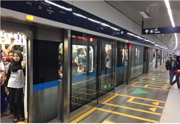
ホームドアと整列乗車ラインが導入された下ベンドンガンヒリル地下駅構内（清水建設）
