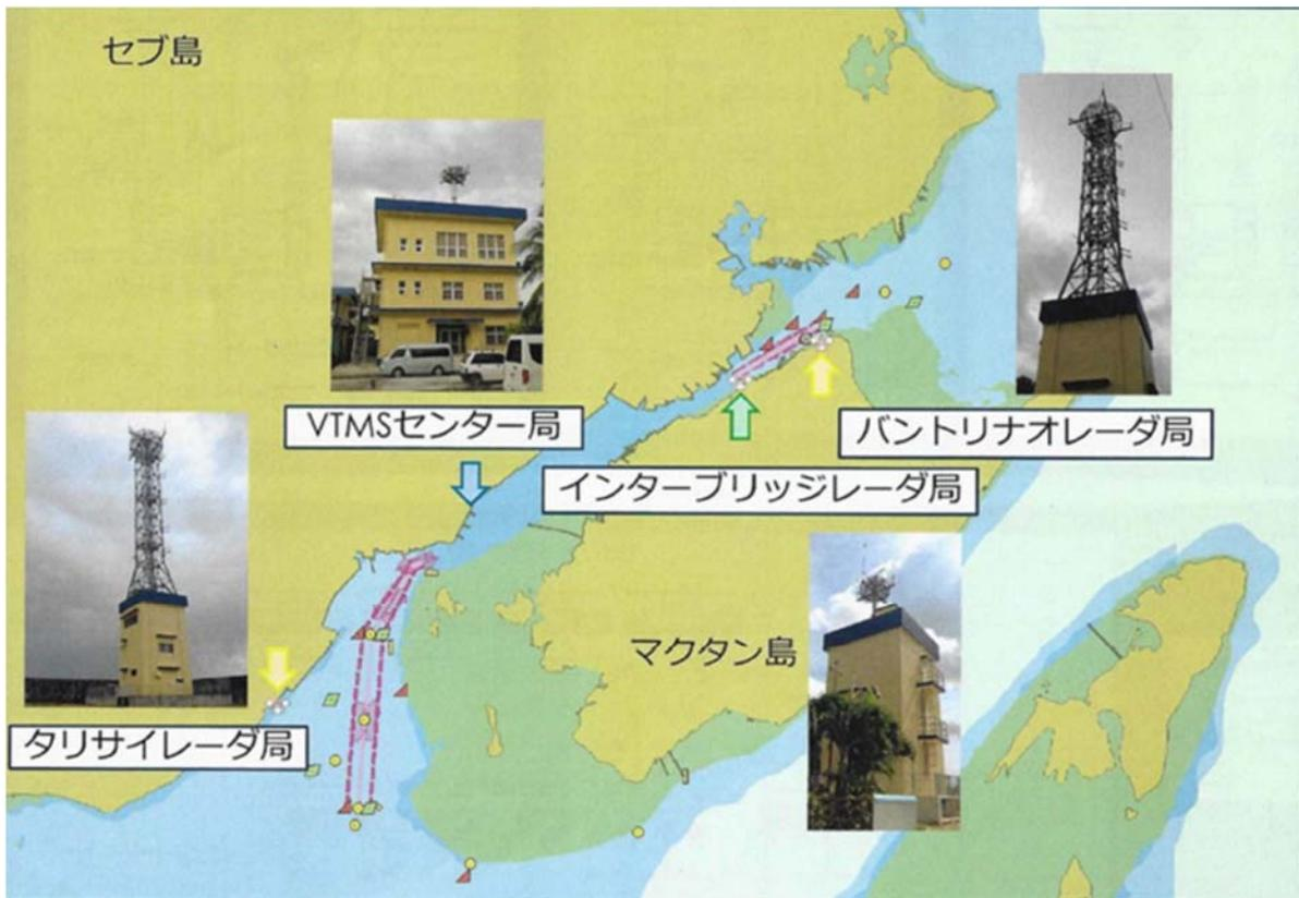
船舶航行監視システム（VTMS）施設構成
