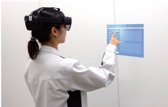
Microsoft社のMRスマートグラスを活用。デバイス越しに点検表や不具合箇所（タブ、範囲）が表示されるなど、現場作業がスムーズに。
